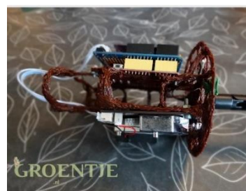
Inwendige van de door SMAL Zeist zelf geproduceerde meetsonde voor luchtkwaliteit..
